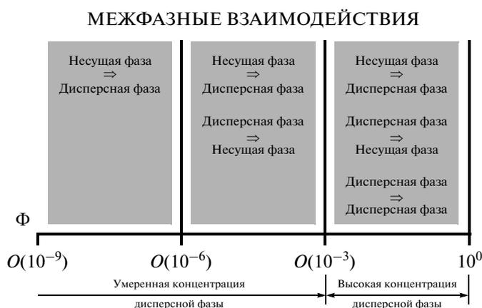
**Рис. 1.** Классификация гетерогенных потоков по объемной концентрации дисперсной фазы.
