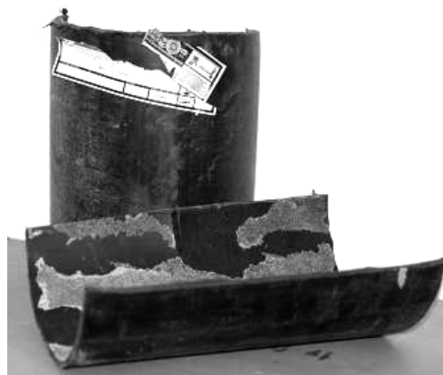
Рисунок 13 – Внешний вид композитной полиэтиленовой трубы-оболочки Ø315 мм (ЗАО «Завод полимерных труб»).
