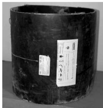
Рисунок 12 – Внешний вид композитной полиэтиленовой трубы-оболочки Ø560 мм (ООО «СарматТермо-Инжиниринг»).
