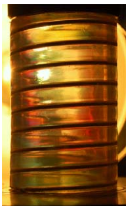
Рисунок 1 – Картина изохром при осевом сжатии композитной трубы (полиуретан, армированный стальной проволокой в форме спирали)
