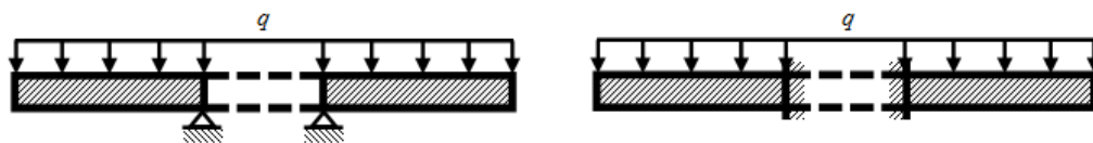
Рис.5. Условия закрепления кольцевой пластины на внутреннем контуре.
