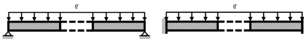
Рис.4. Условия закрепления кольцевой пластины на внешнем контуре.
