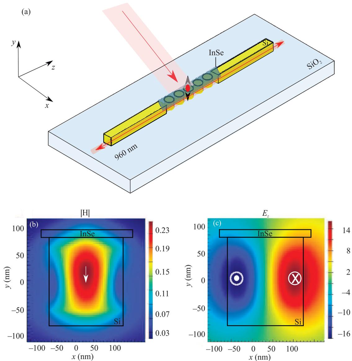
Рис. 1. (Цветной онлайн) (а) – Схематическое изображение системы кремниевого волновода на подложке, центральная часть которого представляет собой кремниевые нанорезонаторы, покрытые 10 нм пленкой селенида индия InSe. (б), (с) – Распределения магнитного и электрического полей в сечении центрального кремниевого диска диаметром 260 нм, отвечающие магнитному дипольному Ми-резонансу при возбуждении точечным излучателем, расположенным в пленке InSe
