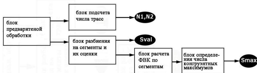
Рис. 5. Блок-схема алгоритма расчета ФВК CMPS методом
