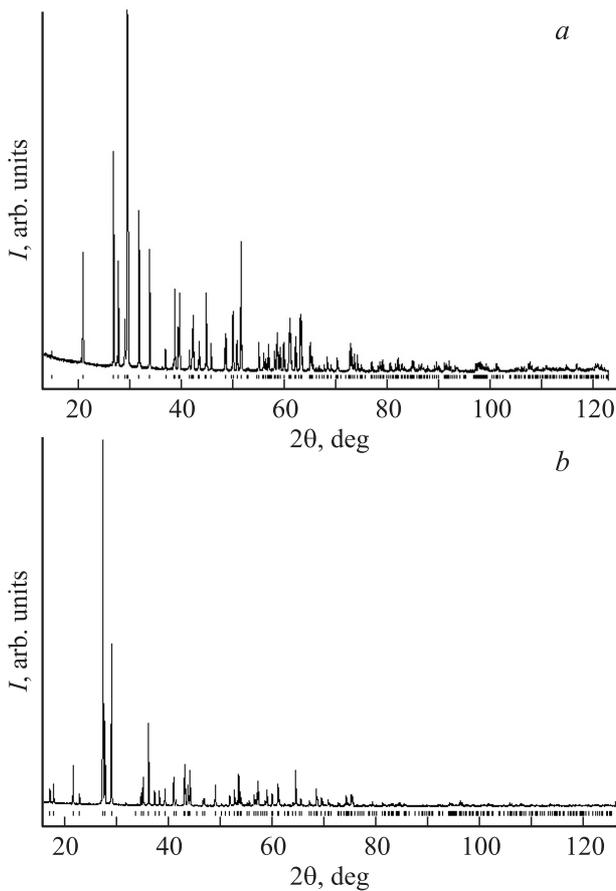
**Рис. 1.** Дифрактограммы  $\text{CuV}_2\text{O}_6$  (a) и  $\text{Cu}_2\text{V}_2\text{O}_7$  (b) при комнатной температуре.
