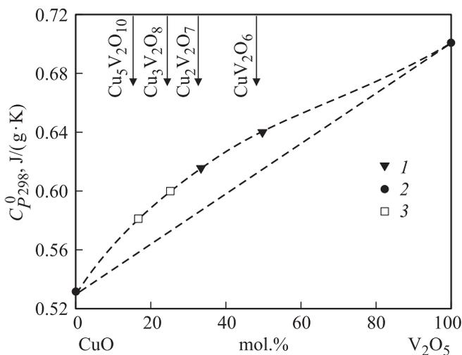
**Рис. 4.** Связь состава и удельных значений теплоемкости системы CuO–V<sub>2</sub>O<sub>5</sub>. 1 — данные настоящей работы, 2 — данные [25], 3 — оценочные значения.
