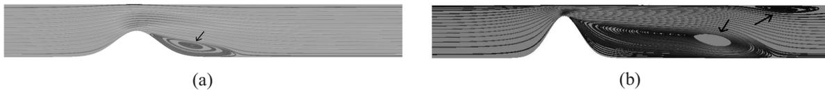
Рис. 5. Распределение линий тока при значениях параметров, соответствующих установлению в системе: (а) — одной застойной зоны, (б) — двух застойных зон (застойные зоны указаны стрелками)
