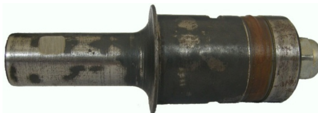
Рис. 1. 1/2-волновой преобразователь продольных колебаний
