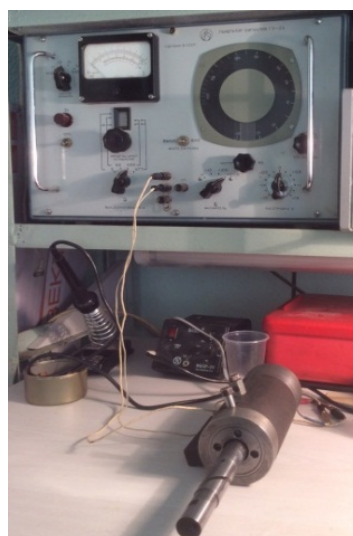
Рис. 17. Замер частоты продольных колебаний
