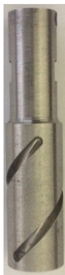
Рис. 16. Концентратор продольно-крутильных колебаний
