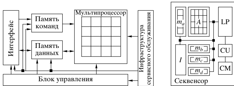
Рис. 6. Архитектура ЛАМП и структура УПУ.
