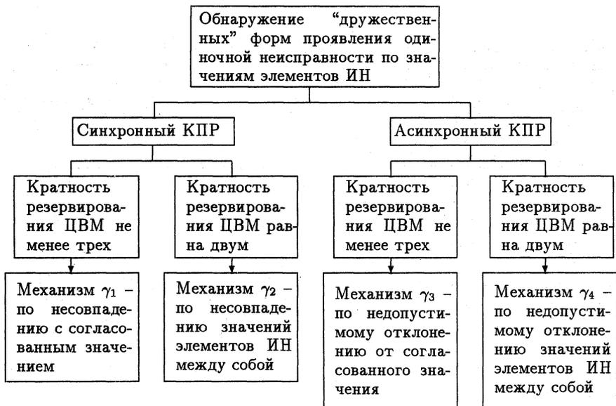
Рис. 3. Механизмы обнаружения "дружественных" неисправностей по значениям элементов ИН в КПП
