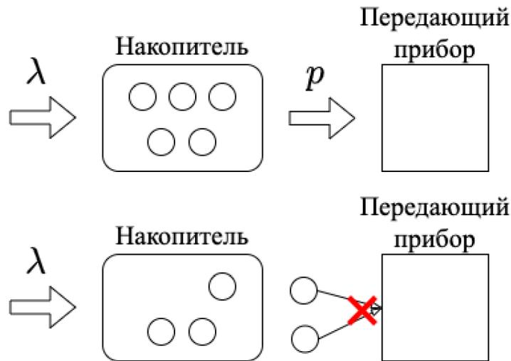
Система случайного множественного доступа, управляемая протоколом ALOHA, снабженная механизмом энергетической подпитки:
